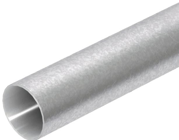
Elektroinstallationsrohr ohne Gewindeenden nach EN 61386-1, für den mechanischen Schutz von Kabeln und Leitungen. Mit gratfreier Innenwand. Korrosionsschutzklasse 4 (hoch).
