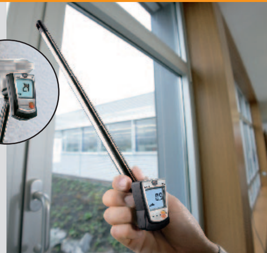
Strömungsmessung an undichten Fenstern
