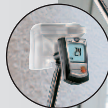
Einfaches Ablesen der Messwerte durch flexibles Gelenk
