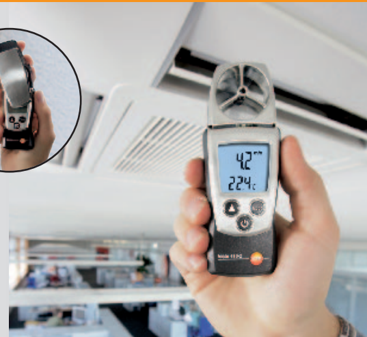
Strömungsmessung am Kanalauslass mit 40 mm-Flügelrad
