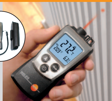
Überprüfung der Oberflächentemperatur eines Heizkörpers mit gleichzeitiger Messung der Umgebungstemperatur
