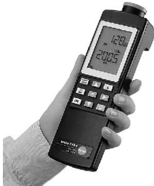
testo 315-1, CO Warn- und Service-Messgerät für Gasheizungen, inkl. Batterie und Kalibrier-Protokoll
